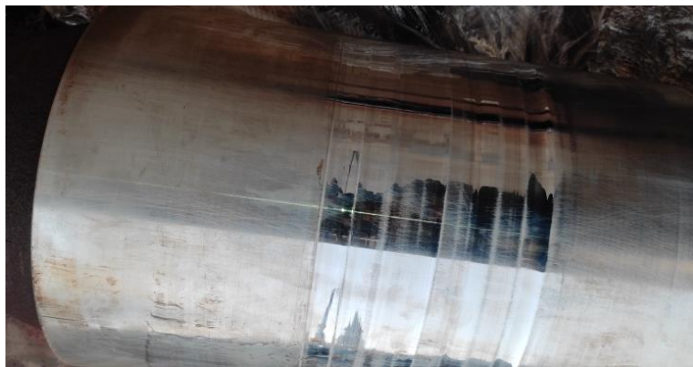
Рисунок 1 – Носовая облицовка гребного вала с кольцевыми выработками
